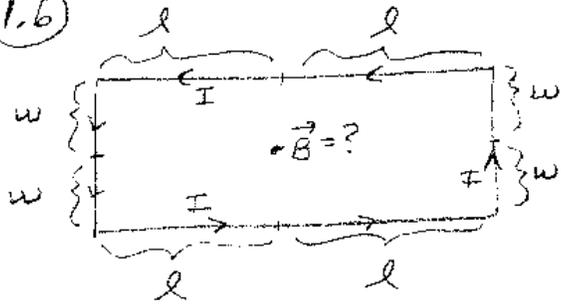
$$\vec{B}_{\text{TOT}} = \vec{B}_L + \vec{B}_R + \vec{B}_T + \vec{B}_B$$
